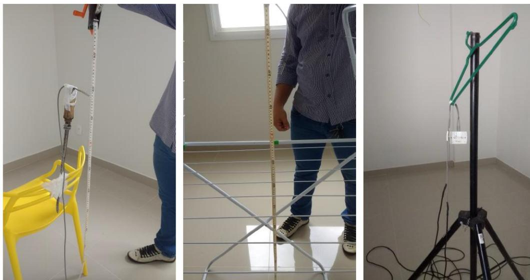
O Data Logger U12-013 da marca Hobo foi o aparelho utilizado para mediação das temperaturas do ambiente internos (quartos e salas). Este aparelho faz a leitura de temperatura e Umidade, possuindo dois canais externos que por sua vez fazem a coleta de dados de somente de temperatura. Trabalha na faixa de medição de temperatura entre  $-20^{\circ}\text{C}$  a  $+70^{\circ}\text{C}$  e umidade ente 5% a 95%. Possui precisão de  $\pm 0,35^{\circ}\text{C}$ , com resolução de 0,03%.
