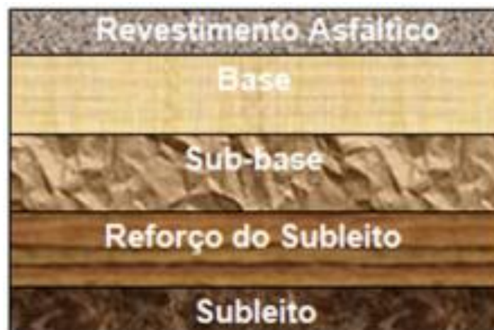
Figura 8 - Camadas de Pavimento Flexível
