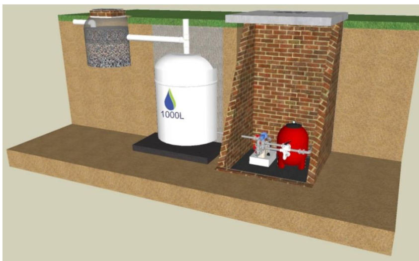
Figura 3 – Representação esquemática do sistema Ecofossa
