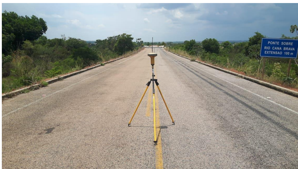
Figura 29 - Aparelho locado no centro da pista.
