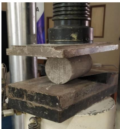
Figura 12 – Ensaio de tração por compressão diametral
