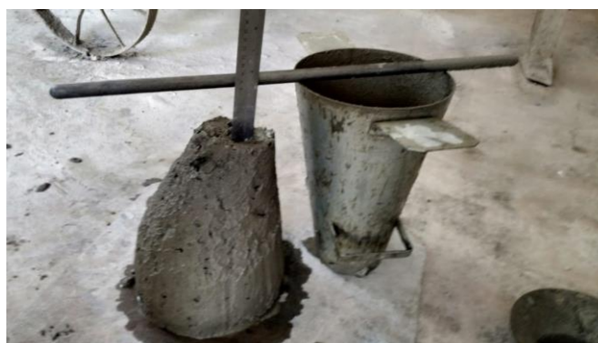
Figura 9 – Ensaio de Abatimento de tronco de cone
