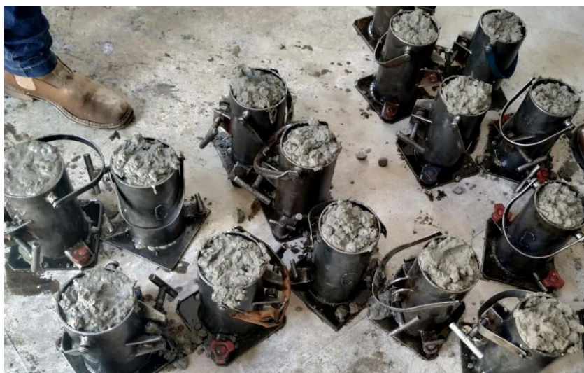
Figura 5 – Moldagem dos corpos de prova
