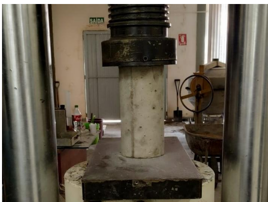
Figura 10 – Ensaio de compressão axial
