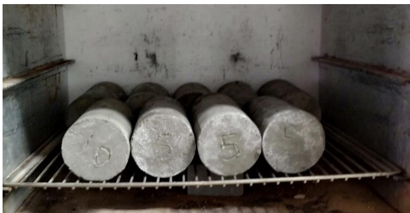
Figura 14 – Corpos de prova na estufa
