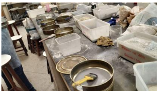
Figura 13: Peneiramento do agregado vítreo
