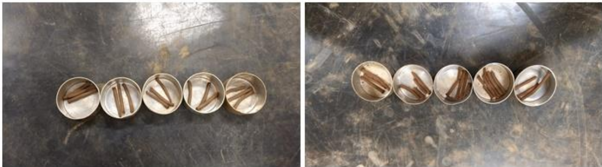
Figura 44 – Amostras do Ensaio de Limite de Plasticidade nas Estações Xambioá e Krahô
