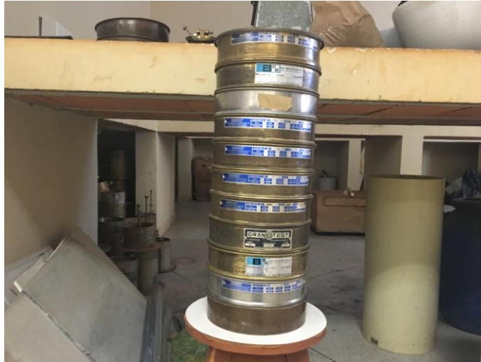
Figura 30 – Conjunto de Peneiras para Ensaio de Granulometria Fonte: Acervo Pessoal (2019)
