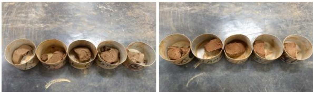
Figura 43 – Amostras do Ensaio de Limite de Liquidez nas Estações Xambioá e Krahô
