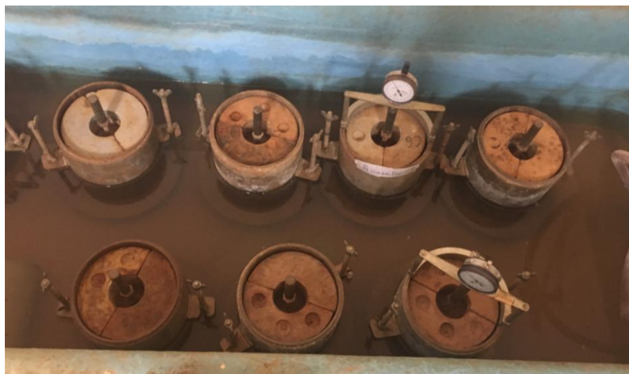
Figura 33 – Corpos de Prova Imersos na Água Fonte: Acervo Pessoal (2019)
