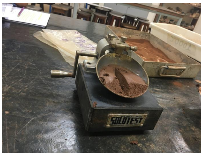
Figura 26 – Aparelho CasaGrande Fonte: Acervo Pessoal (2019)
