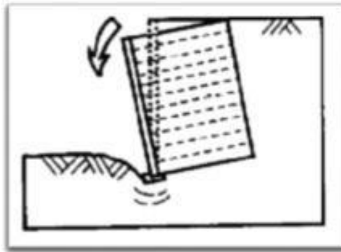
Figura 17. Ruptura no solo de fundação
