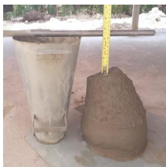
Figura 35 – Ensaio de Slump test traço Brita e Seixo rolado e Seixo britado
