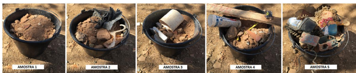
Figura 3. Amostras coletadas no local de descarte de RCC
