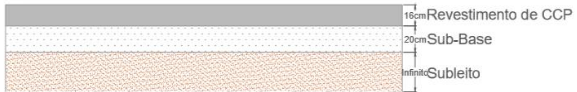
Figura 24 - Estrutura final do pavimento rígido
