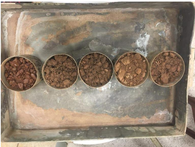
Figura 21 - Ensaio de Compactação - Teor de Umidade
