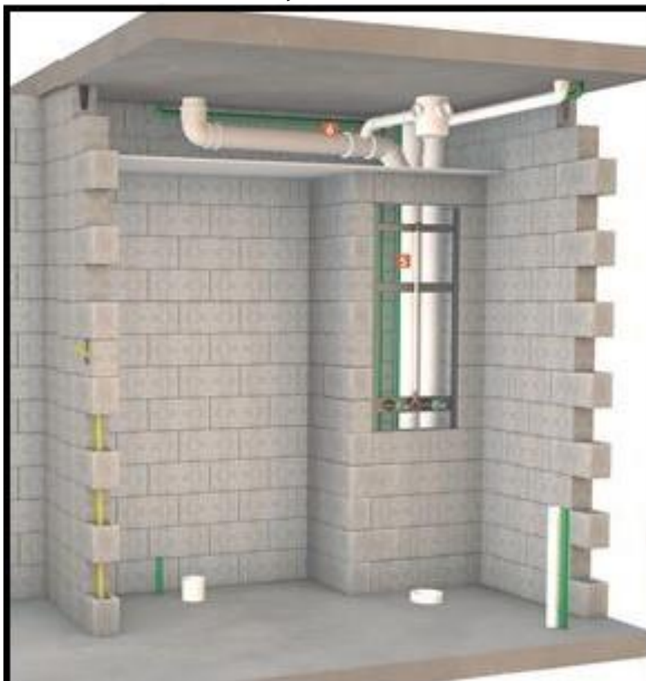
Figura 3: Shaft, e detalhamento da instalação hidrossanitária
