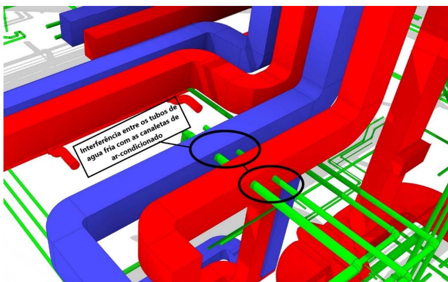
Figura 7: Interferência detectada automaticamente pelo BIM
