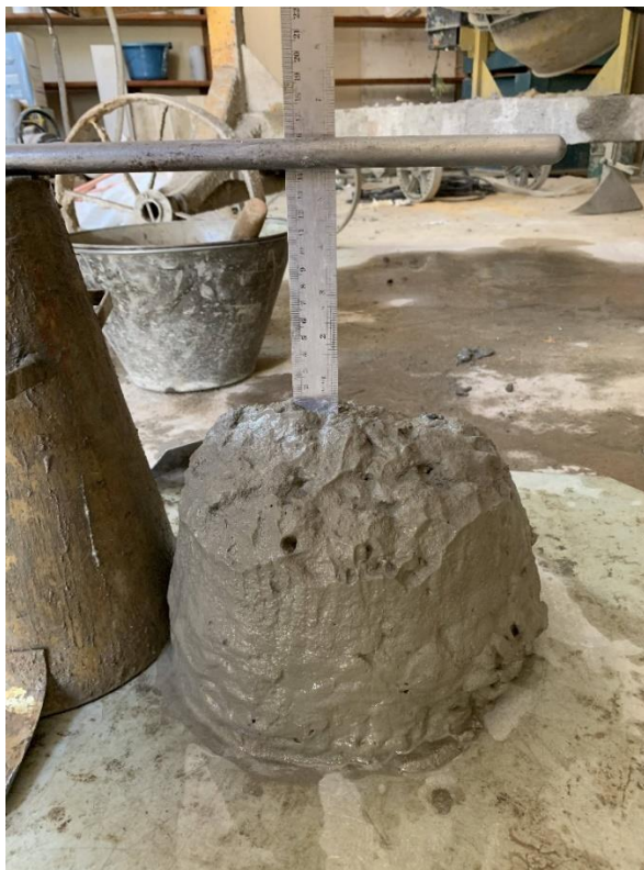
Figura 10 - Abatimento do concreto com 20% de teor de substituição
