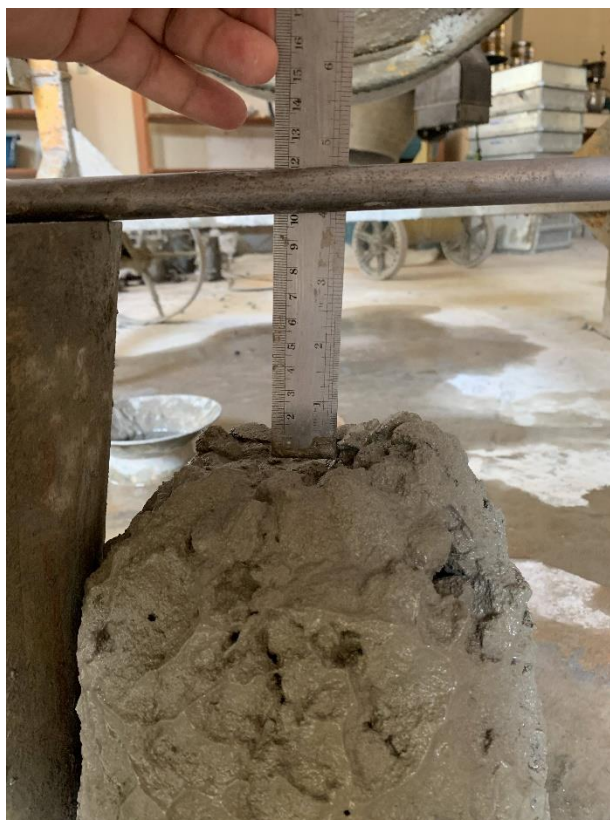
Figura 9 - Abatimento do segundo teste da absorção da vermiculita expandida
