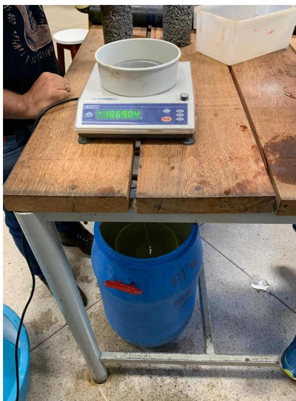
Figura 14 - Corpo de prova imerso em água após fervura
