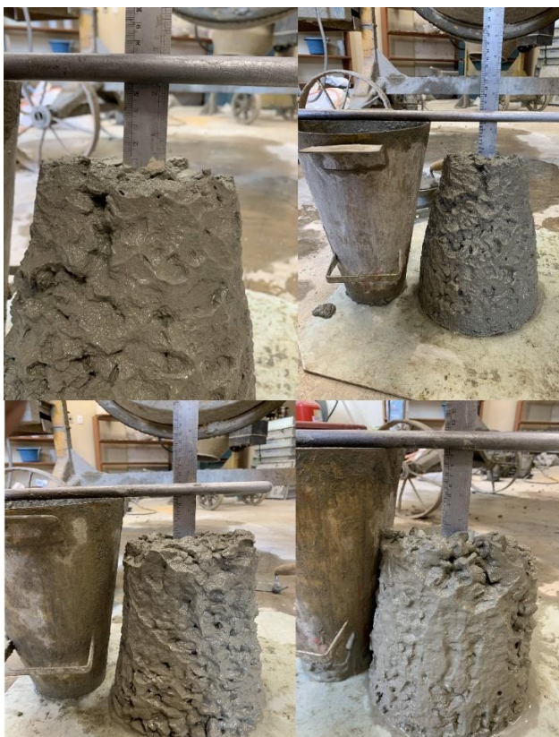
Figura 8 - Abatimento do primeiro teste da absorção da vermiculita expandida
