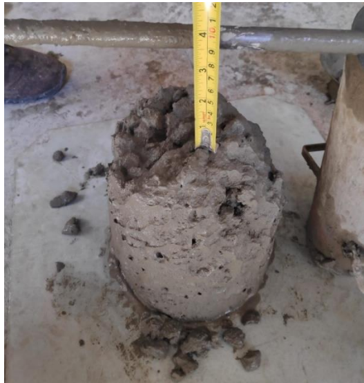
Figura 6: Ensaio de abatimento (slump test).
