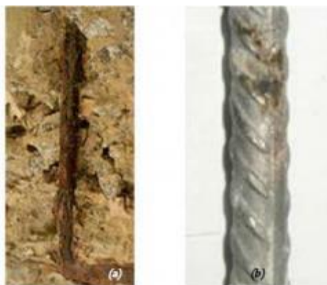
Figura 5 - Corrosão generalizada irregular (a) e corrosão por pites (b).
