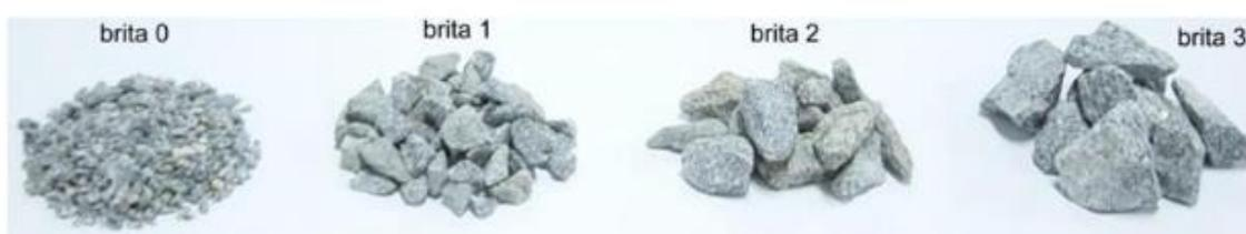
Conforme o Instituto Brasileiro de Concreto (IBRACON) os agregados graúdos devem ser escolhidos pelo tamanho do grão e a forma geométrica. É de grande importância a composição granulométrica do agregado, pois pode haver alterações na composição do concreto.
