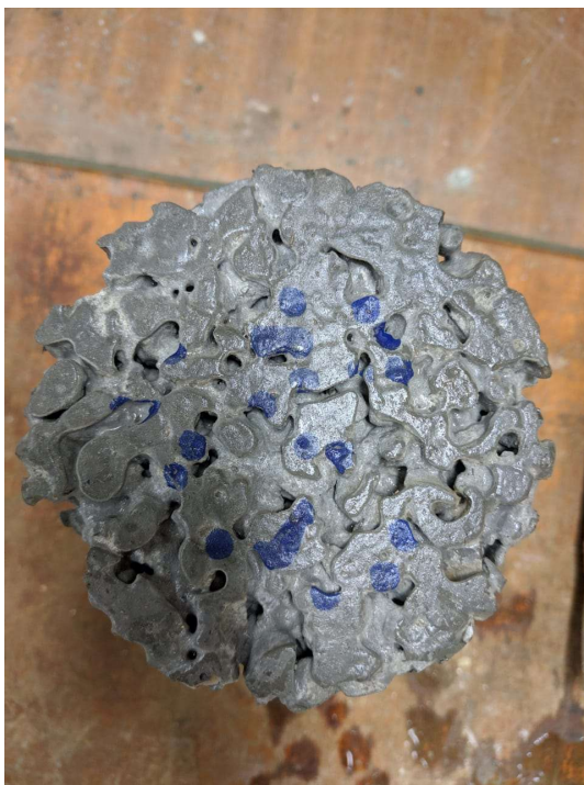
Figura 16 – Boas condições de porosidade no traço referência
