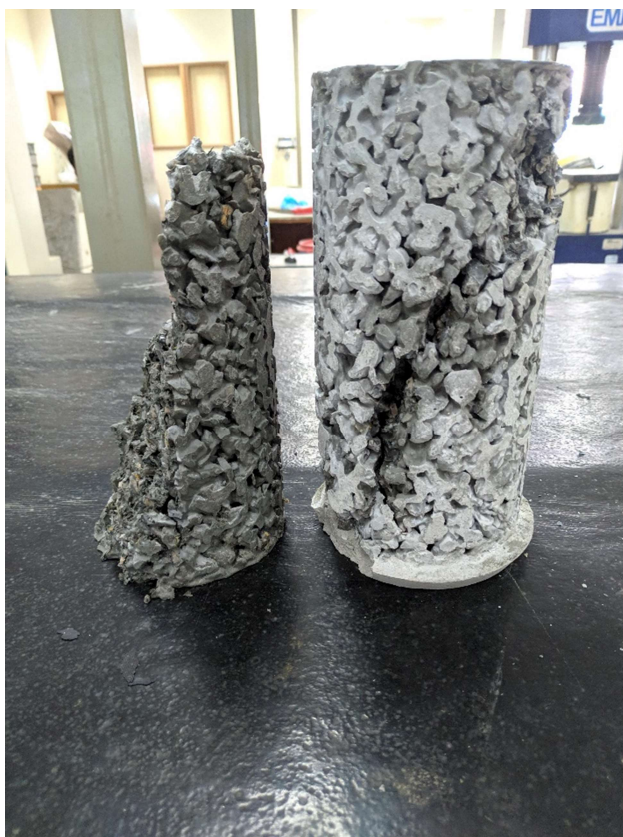
Figura 19 - CP's com ruptura cisalhada lateral
