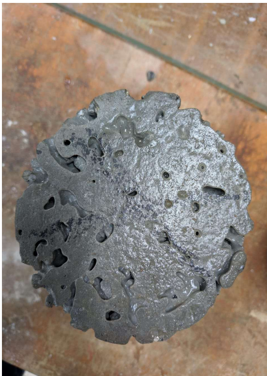
Figura 17 - Início de colmatação traço de substituição
