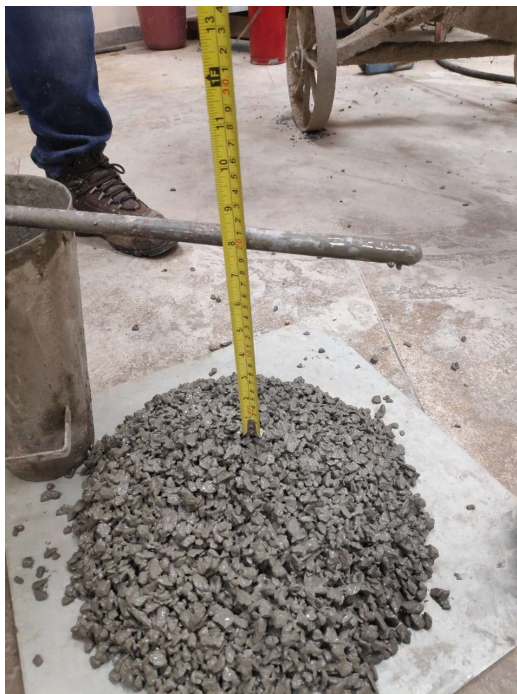
Figura 13 - Slump Traço Referência
