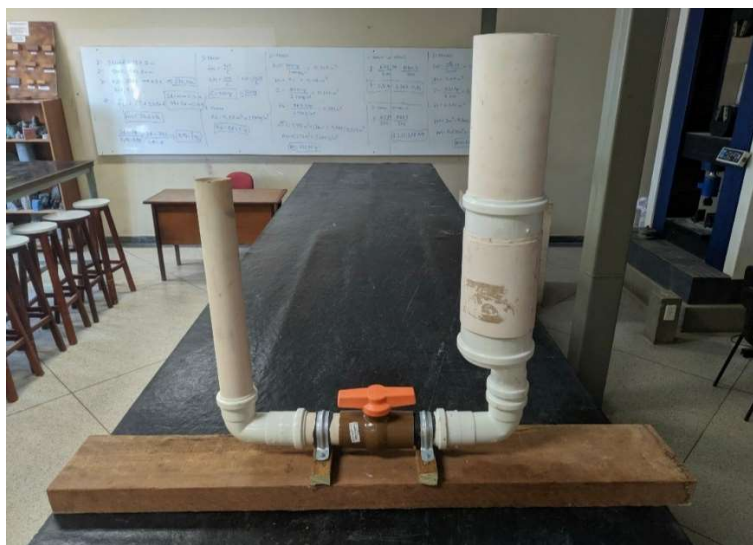
Figura 10 - Exemplo do permeâmetro que foi utilizado
