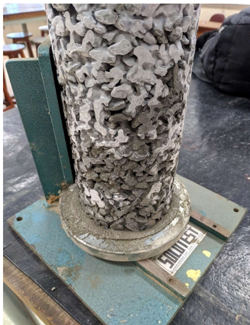
Figura 18 - Capeamento do corpo de prova
