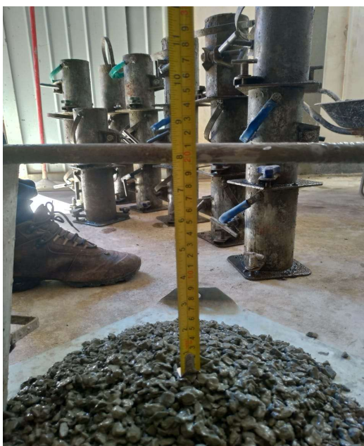
Figura 14 - Slump traço 5%
