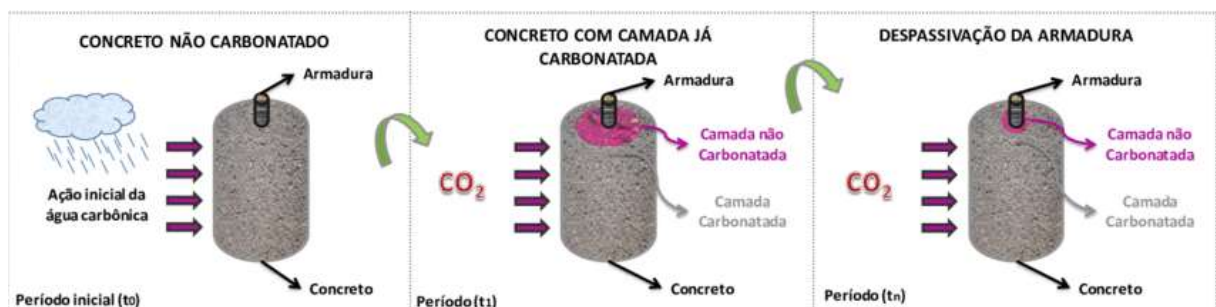
Figura 17 - Representação da frente de carbonatação ao longo do tempo
