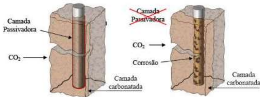
Figura 18 - Representação esquemática do avanço da frente de carbonatação
