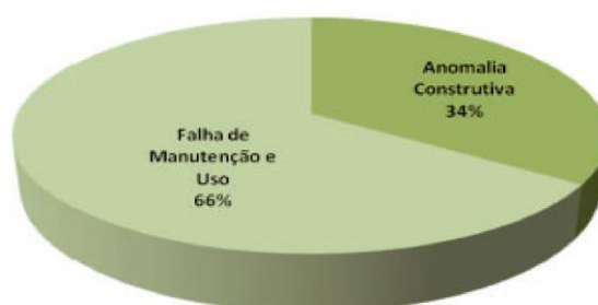
Figura 2 - Distribuição da incidência de acidentes prediais por tipo de origem.
