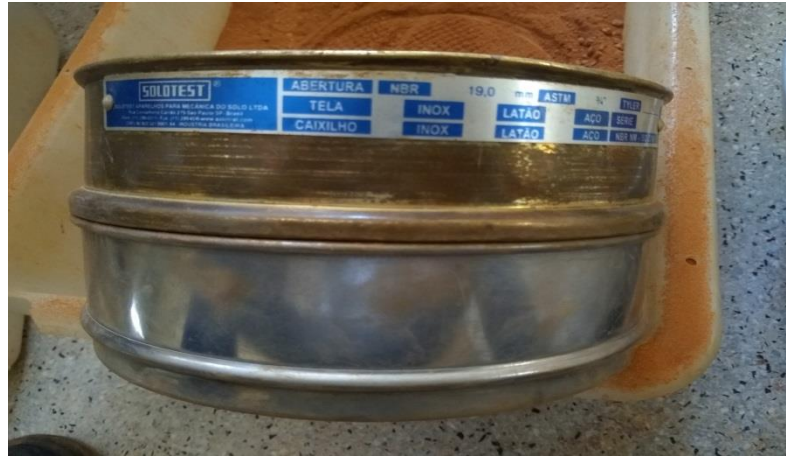
Figura 9 – Peneiramento da amostra.
