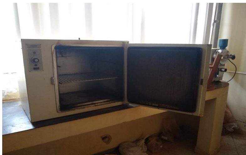
Figura 17 – Secagem da amostra.
