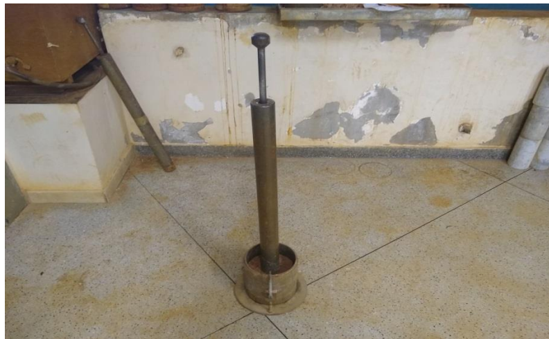
Figura 14 – Compactação por camadas.
