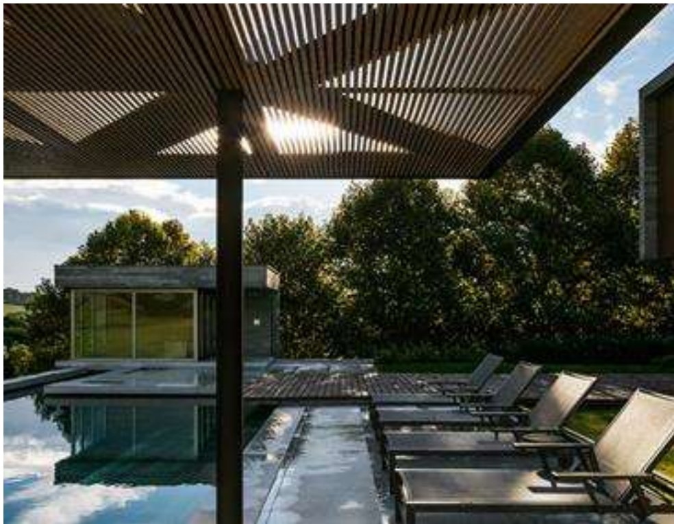
Figura 06: Sombreamento com Pérgula. (utilização de ‘travessões’ de materiais como concreto armado, ferro, vigas de madeira, alumínio, bambú).
