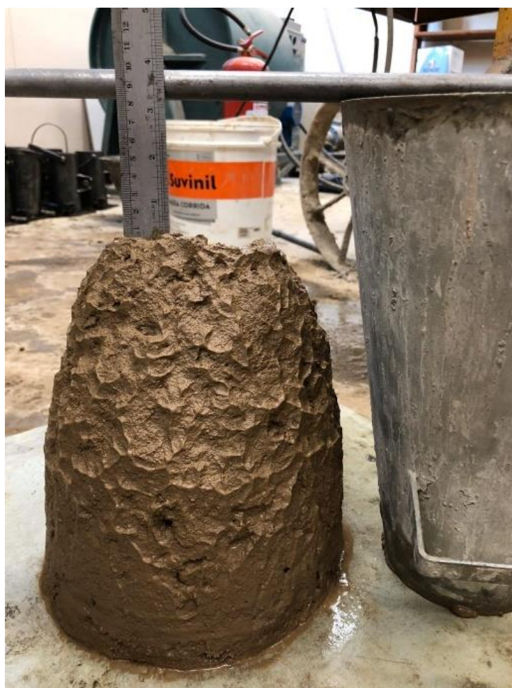
Figura 9 - Abatimento do concreto de 10% de teor de substituição
