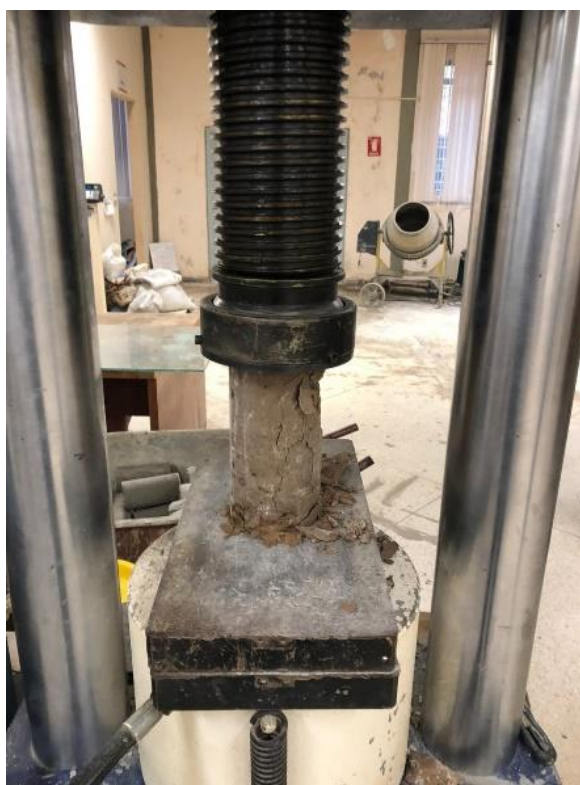
Figura 10 - Corpo de prova na prensa hidráulica rompido a compressão simples
