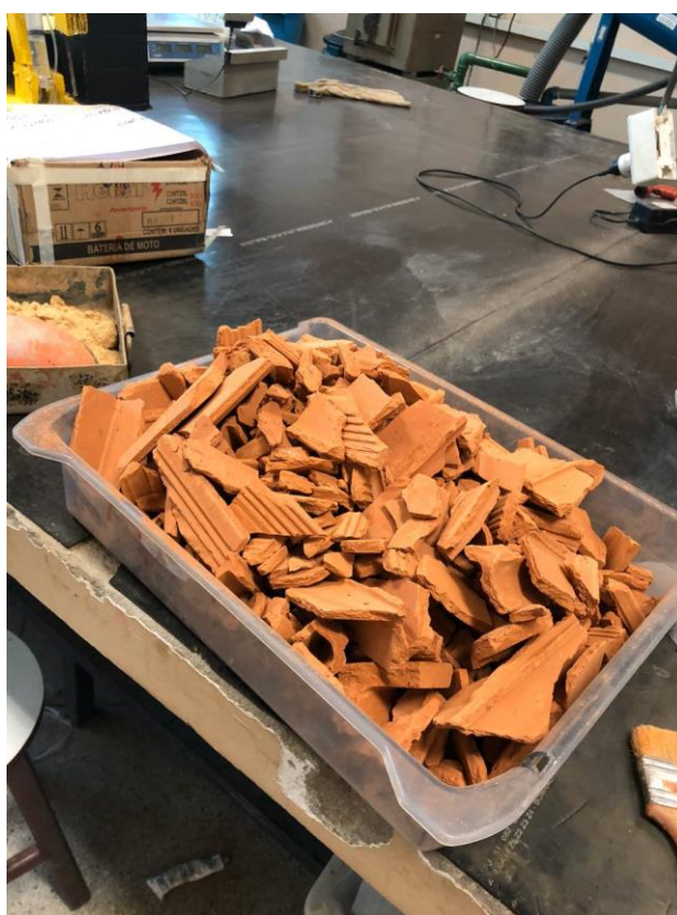
Figura 5 - Resíduo cerâmico fragmentado pronto para ser inserido no moinho de bolas
