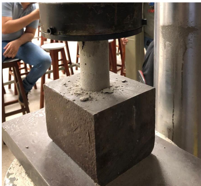
Figura 8 - Corpo de prova rompido
