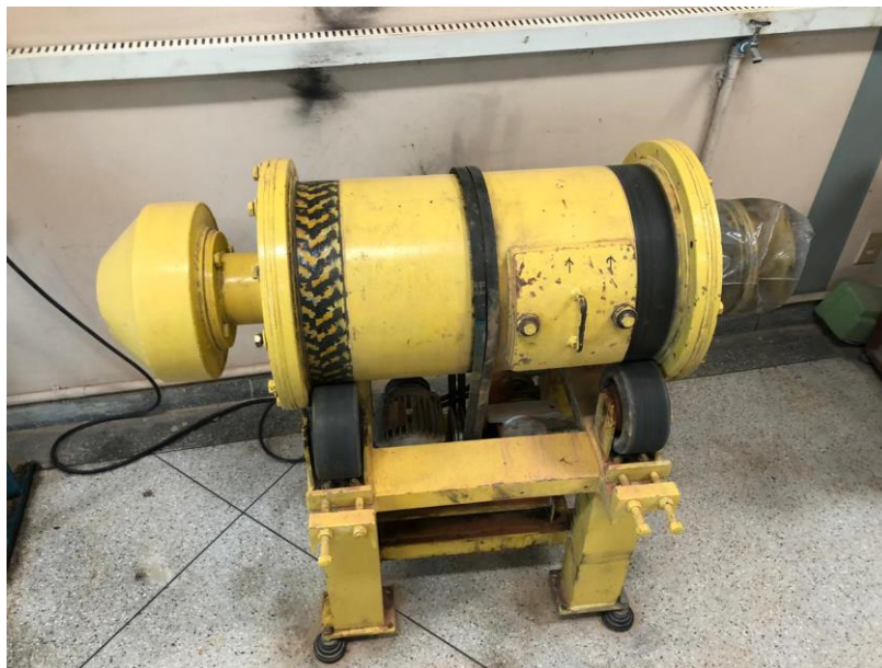
Figura 6 - Moinho de bolas utilizado no beneficiamento do material
