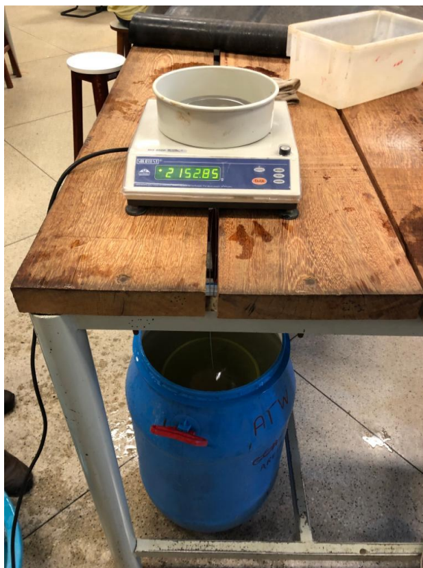
Figura 13 - Corpo de prova imerso em água após fervura
