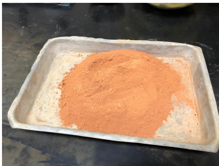
Figura 7 - Resíduo cerâmico passante na peneira 75\ \mu\text{m}
