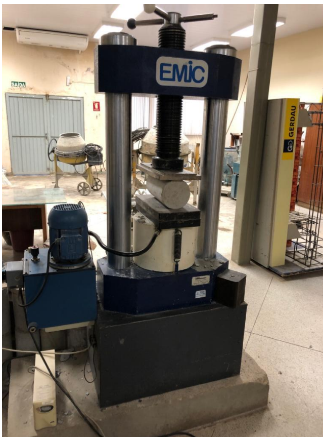
Figura 11 - Corpo de prova sendo realizado o ensaio a tração por compressão diametral
