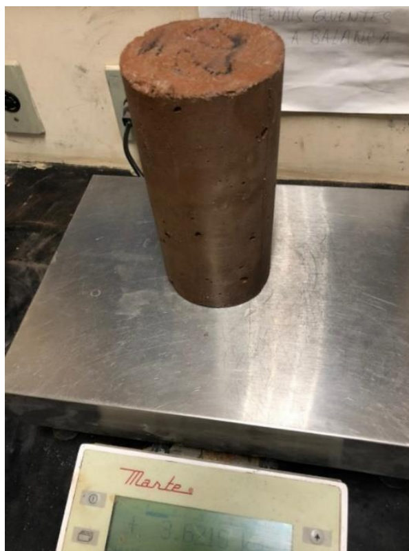
Figura 12 - Pesagem do corpo de prova saturado em água.
