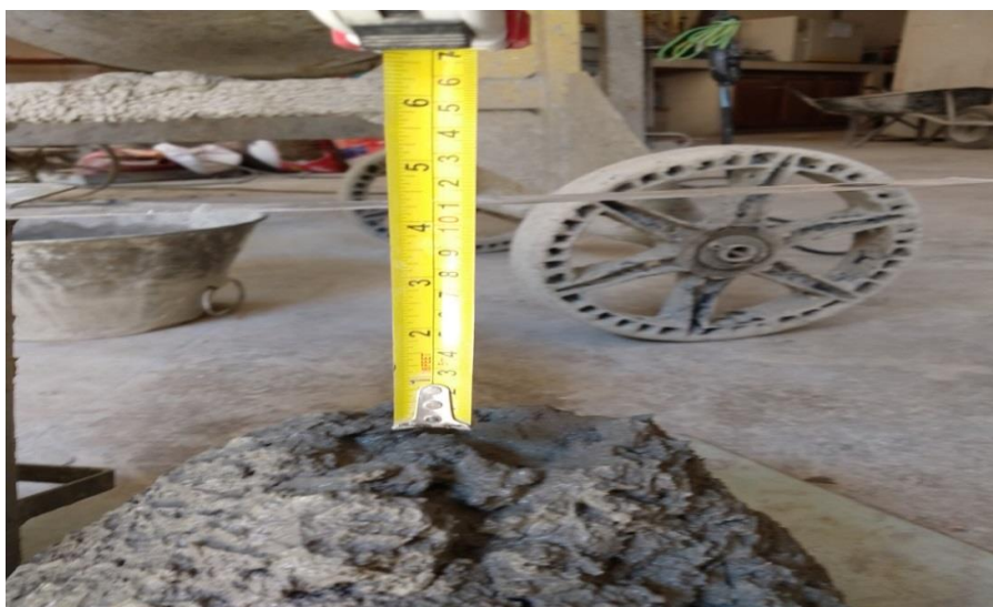
Figura 19 – Slump test do concreto 60% de substituição.
