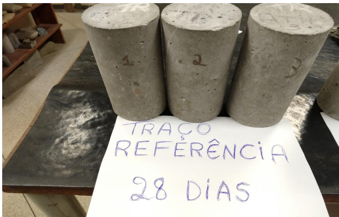
Figura 23 – Inspeção visual nos corpos de prova
