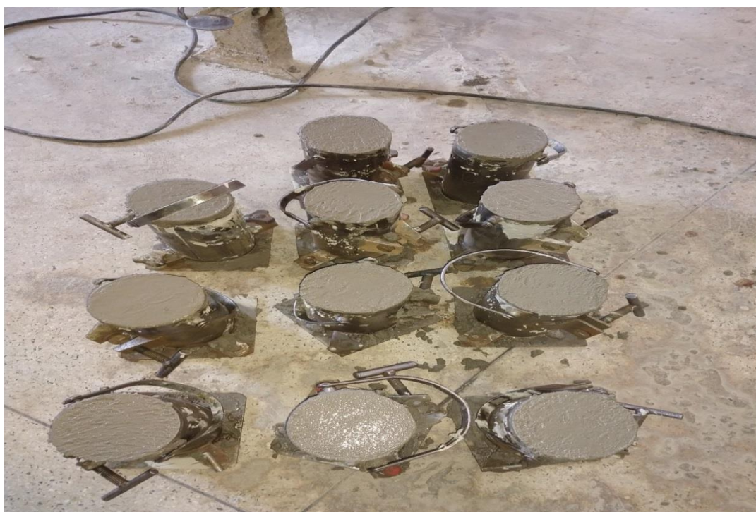
Figura 20 – Moldes preenchidos com concreto
