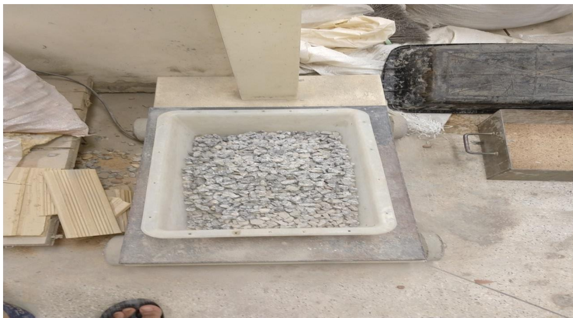
Figura 15 – Teste da massa unitária do agregado graúdo
