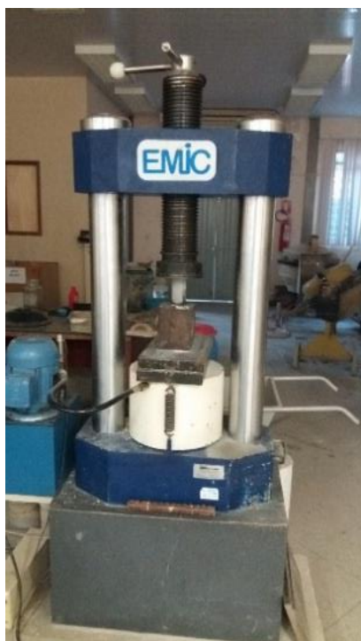
Figura 19: Ensaio de resistência a compressão na prensa EMIC PC 201
