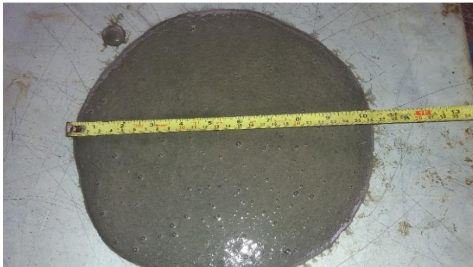
Figura 29: Espalhamento do traço de substituição de 5% do cimento por CCA
