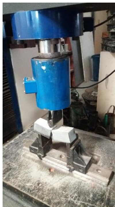
Figura 20: Ensaio de tração na flexão máquina EMIC DL 1000
