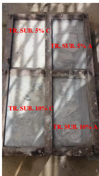
Figura 33: Protótipos dos traços de substituição de cimento e agregado miúdo por CCA
