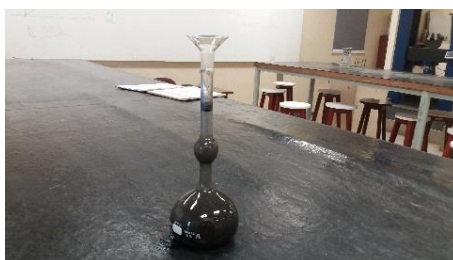
Figura 16: Ensaio de massa específica da CCA
