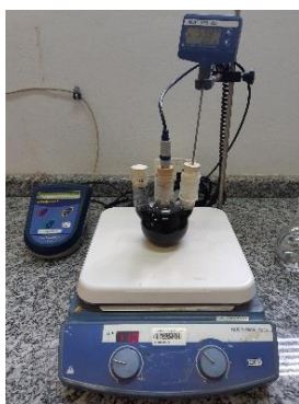
Figura 17: Ensaio de reatividade pozolânica
