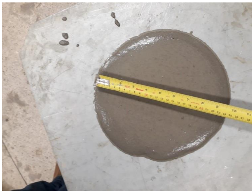
Figura 31: Espalhamento do traço de 5% de substituição da areia por CCA
