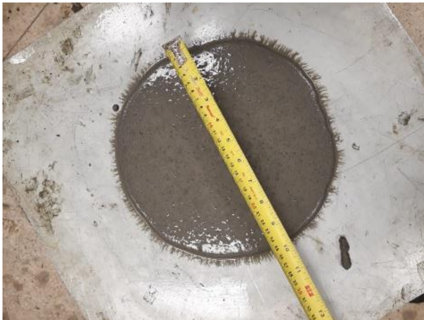
Figura 30: Espalhamento do traço de substituição 10% de cimento por CCA
