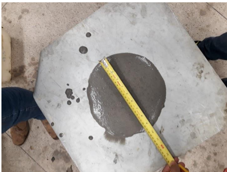
Figura 32: Espalhamento do traço de 10% de substituição da areia por CCA
