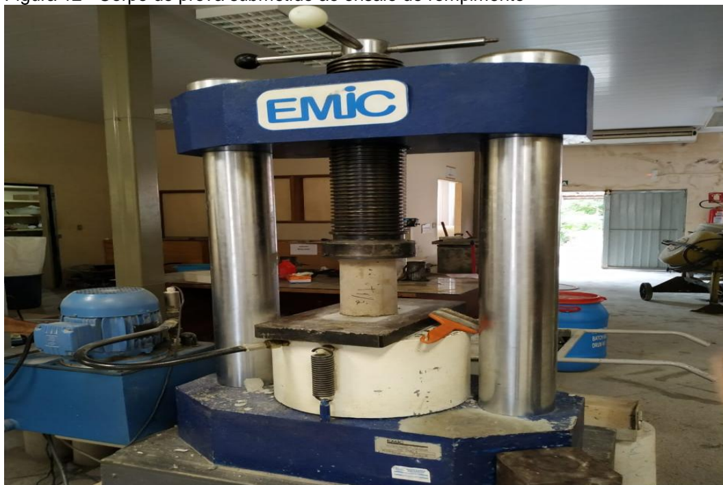
Figura 12 - Corpo de prova submetido ao ensaio de rompimento
