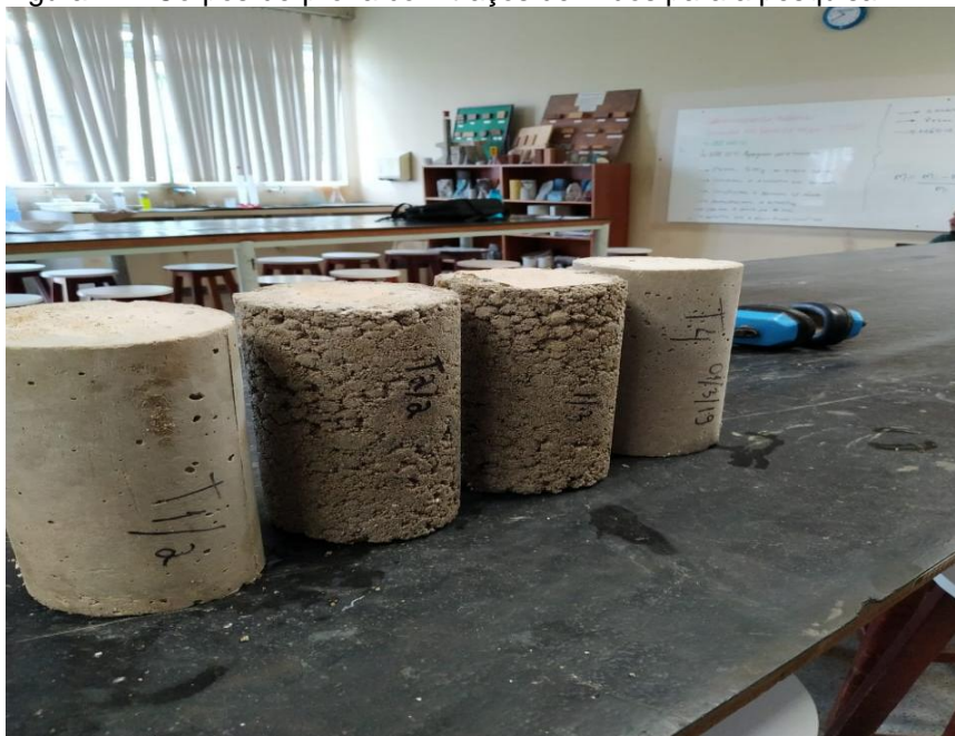
Figura 11 - Corpos-de-prova com traços definidos para a pesquisa
