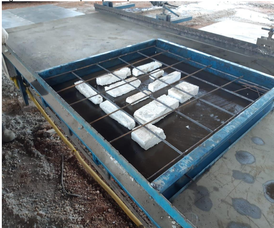
Figura 14 - Forma de produção de placa de fechamento
