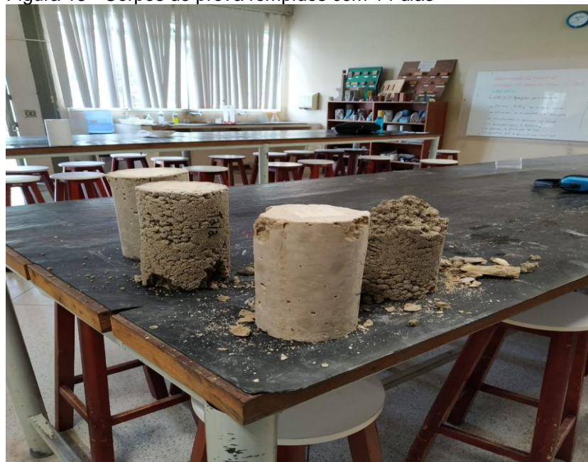
Figura 13 - Corpos de prova rompidos com 14 dias
