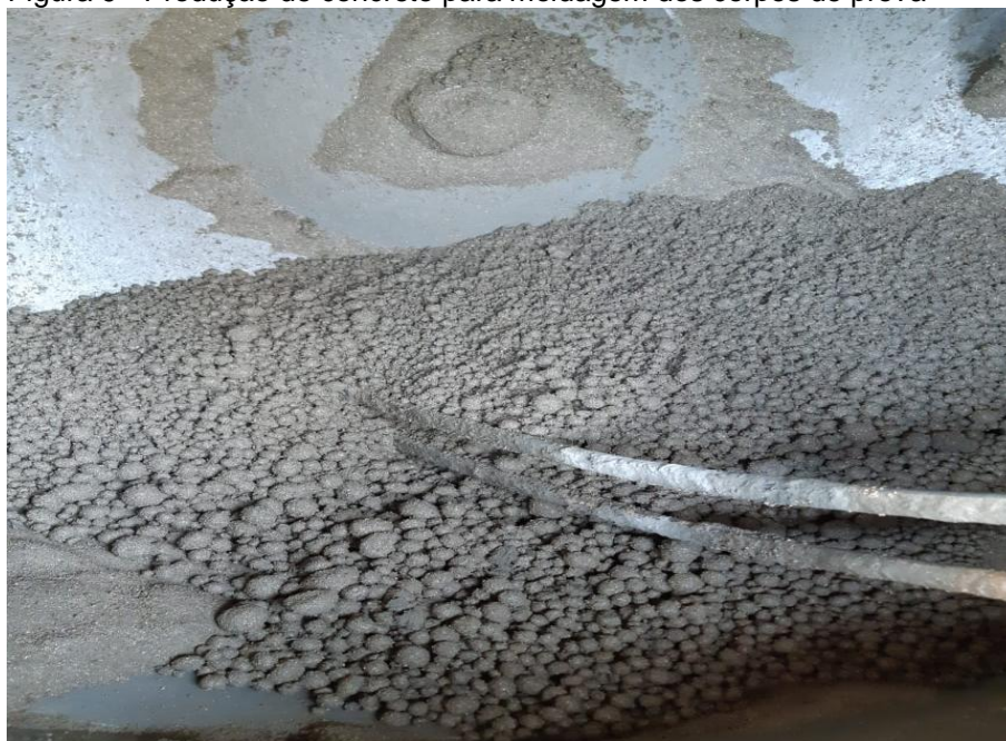
Figura 9 - Produção de concreto para moldagem dos corpos de prova
