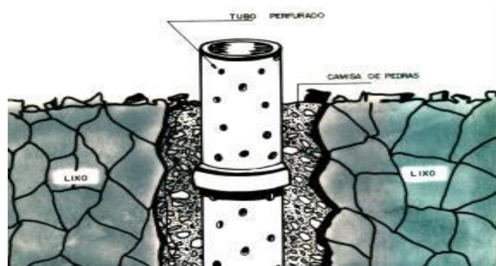
Figura 2 - Detalhe do dreno de captação de gases no aterro sanitário
