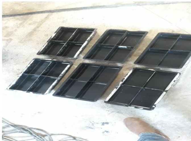
Figura 24 – Fôrmas para os pavers
