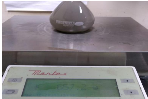
Figura 22 – Picnômetro com pó de vidro
