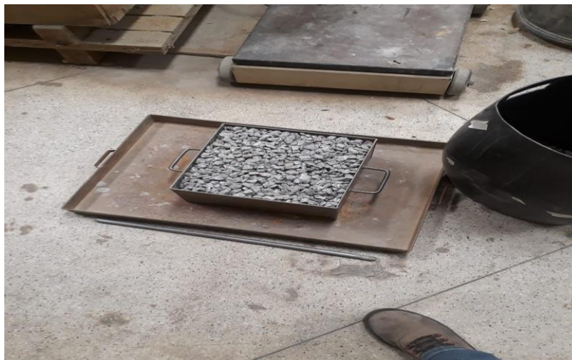
Figura 18 – Teste massa unitária agregado graúdo
