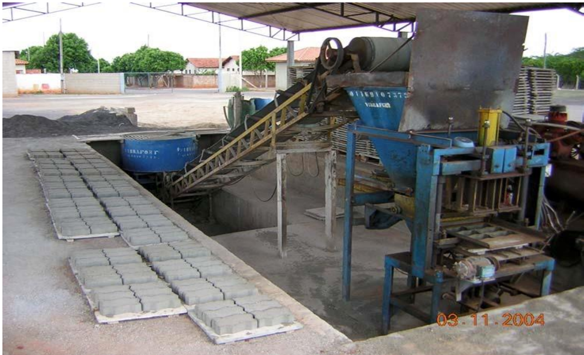
Figura 8 – Moldagem de blocos intertravados em uma vibroprensa semi-automática
