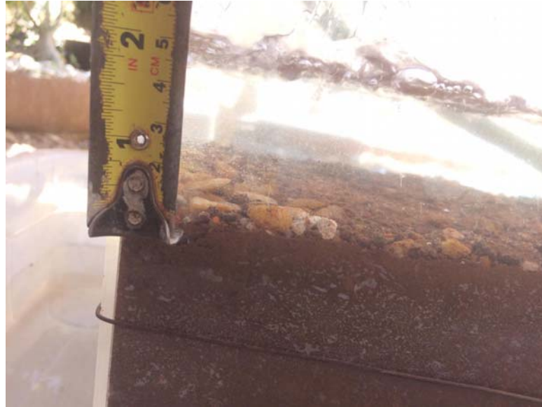
Figura 20 – Altura de coluna de água após o vazamento.
