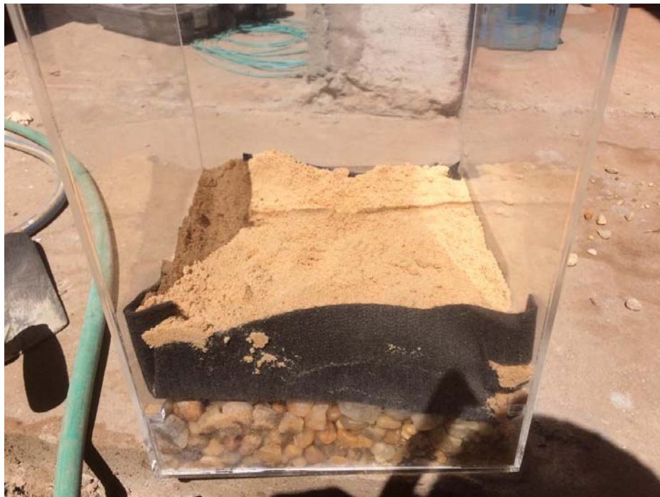
Figura 12 – Camadas de Seixo, Geotêxtil e areia.
