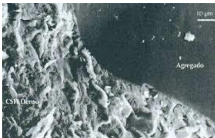
Figura 8 – Ausência da zona de transição entre pasta e agregado em um concreto com sílica ativa.
