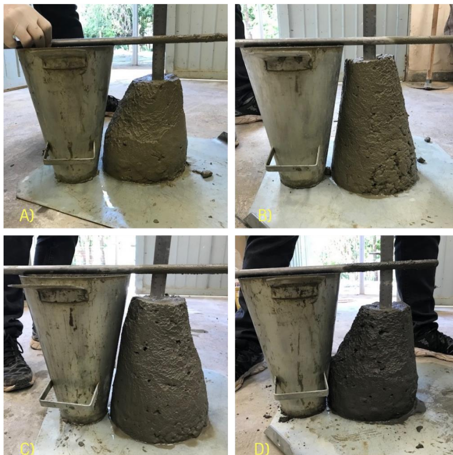
Figura 15 – Ensaio de abatimento do tronco de cone. A) traço referência; B) traço com 5% de substituição; C) traço com 10% de substituição; D) traço com 20% de substituição.
