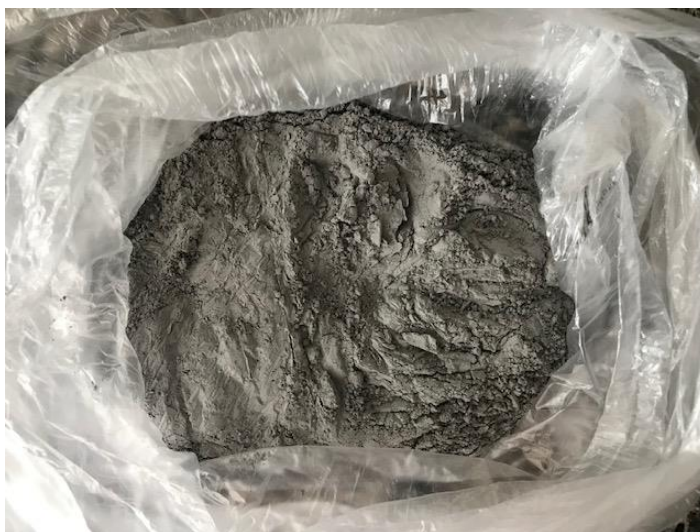
Figura 13 – Cinza da folha de bananeira após a queima, moagem e peneiramento.
