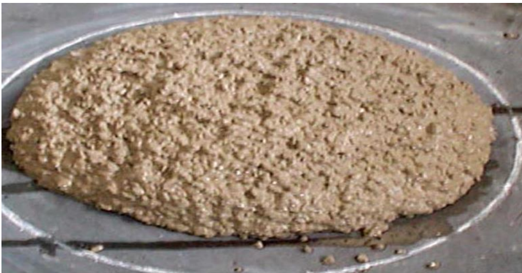
Figura 10 : Ensaio com slump flow test e slump flow T 50cm test.
