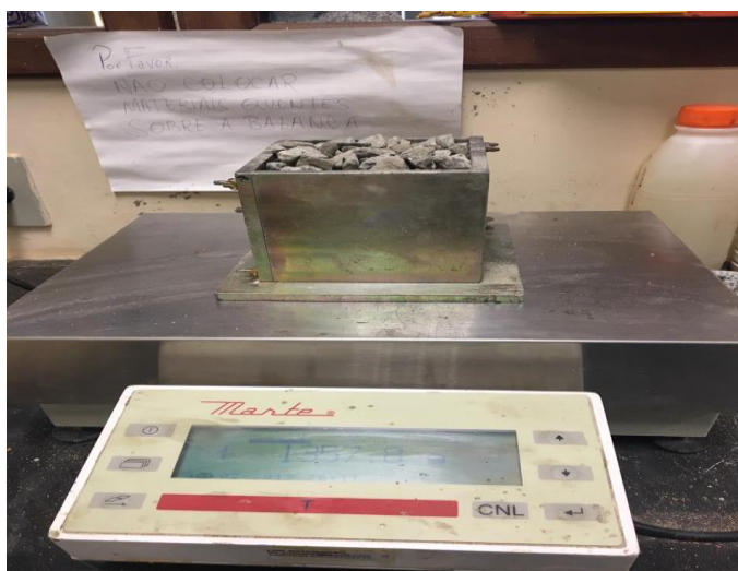
Figura 5 - Determinação da massa unitária do agregado graúdo.
