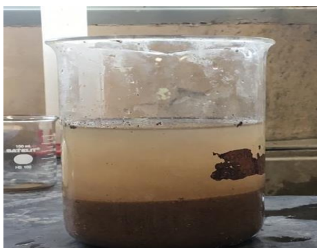
Figura 7 - Determinação do teor de materiais pulverulentos.
