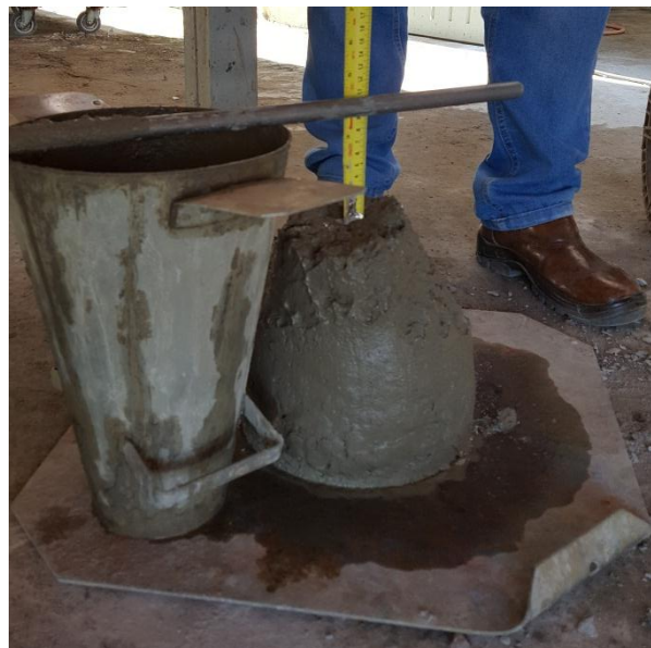
Figura 22 - Ensaio de abatimento do concreto com 7% de resíduo de tinta
