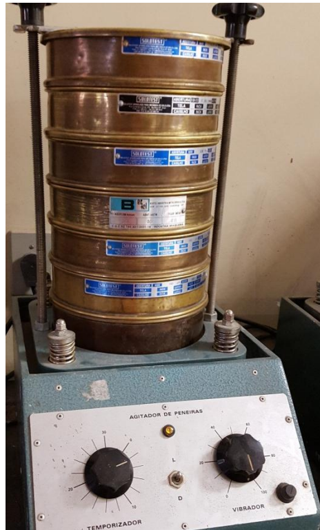
Figura 14 - Ensaio de Granulometria do Agregado Miúdo
