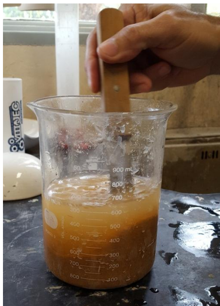
Figura 18 - Determinação de percentual de material pulverulento no agregado miúdo
