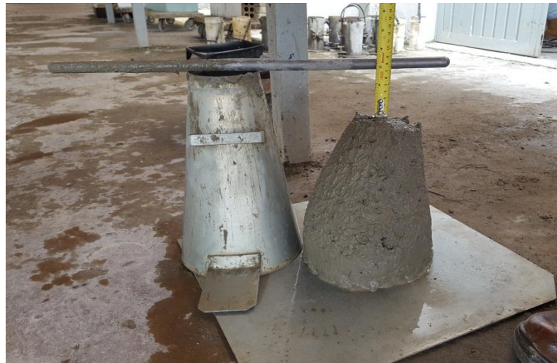
Figura 19 - Ensaio de abatimento do concreto referência
