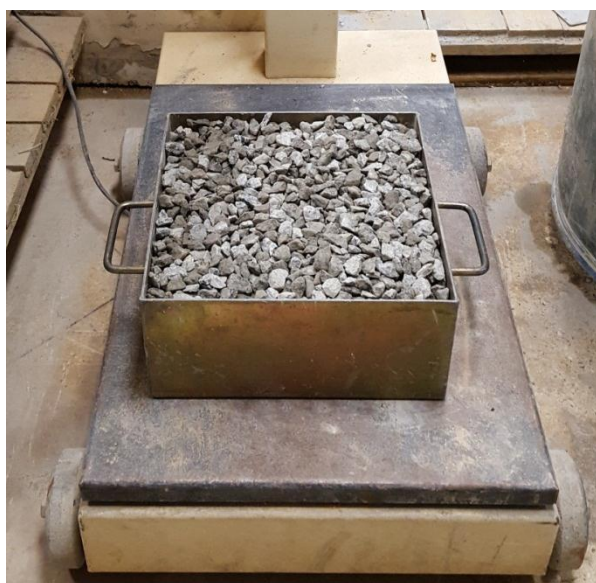
Figura 11 - Ensaio de massa unitária do agregado graúdo
