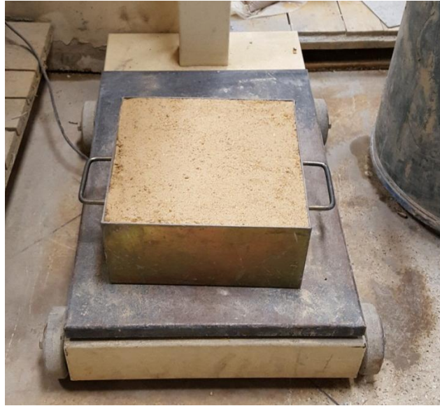
Figura 12 - Ensaio de massa unitária do agregado miúdo
