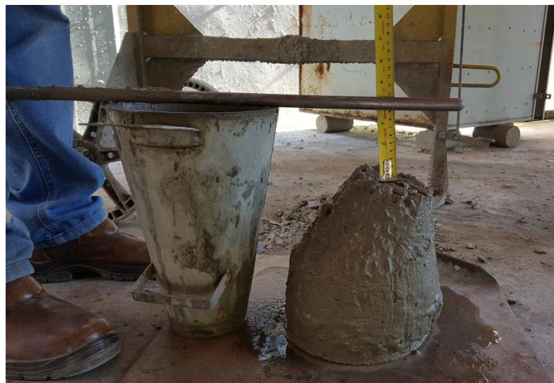
Figura 20 - Ensaio de abatimento do concreto com 3% de resíduo de tinta
