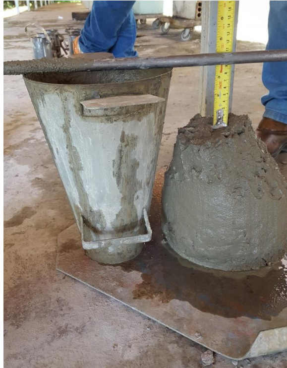
Figura 21 - Ensaio de abatimento do concreto com 5% de resíduo de tinta
