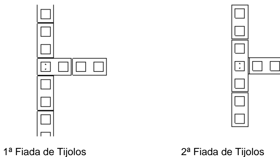
Figura 35 - Amarração de parede em "T" - Planta baixa
