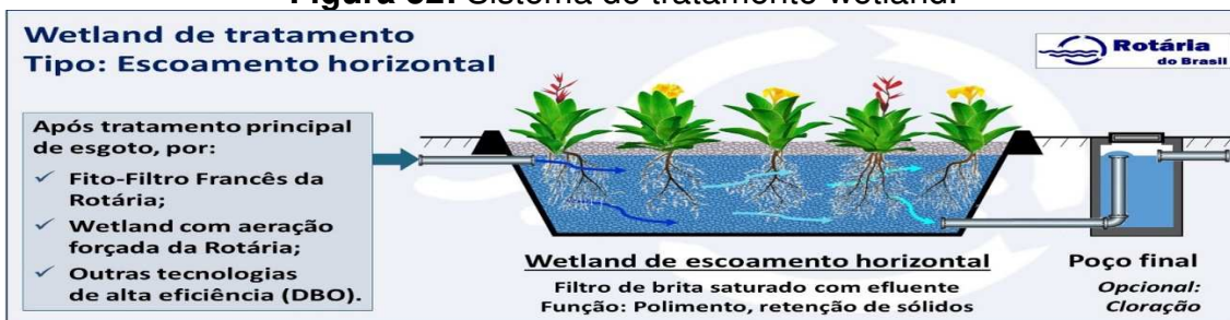
Figura 52: Sistema de tratamento wetland.
