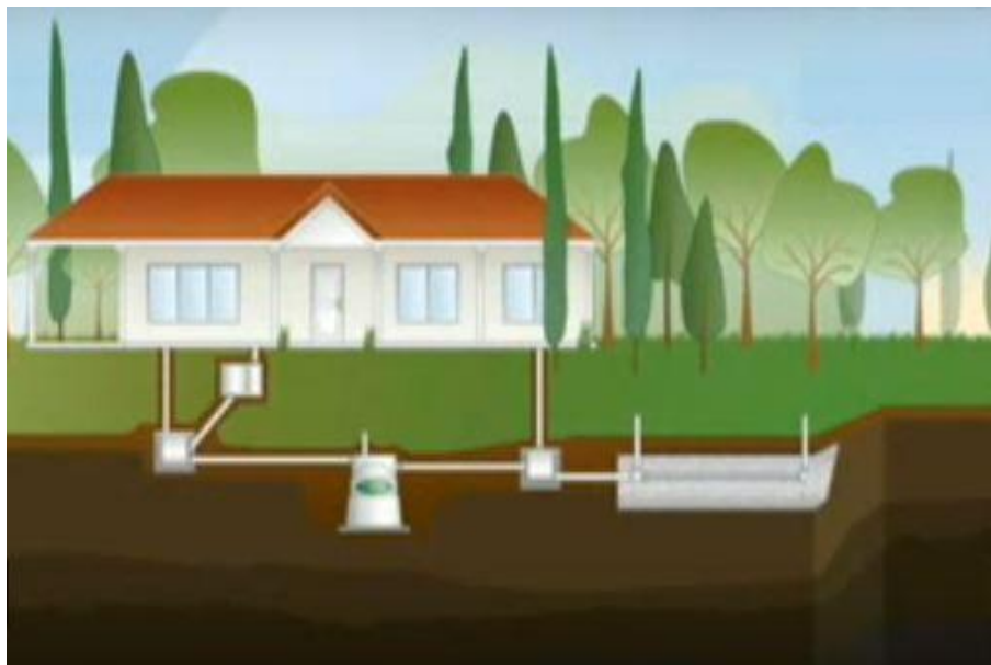
Figura 39 - Esquema de sistema ecológico de tratamento de esgoto
