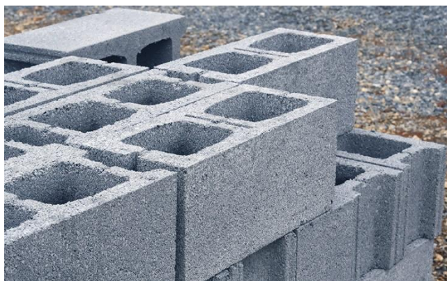
Figura 34: Bloco de Concreto.
