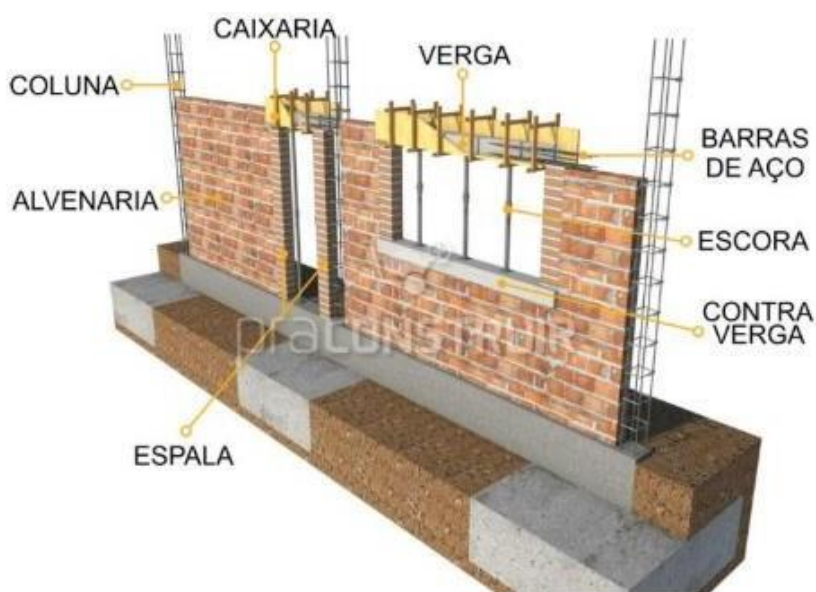
Figura 45 – Vedação em blocos cerâmicos
