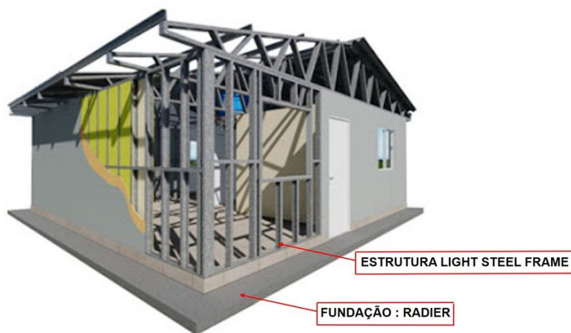
Figura 23: Identificação do sistema construtivo e da fundação
