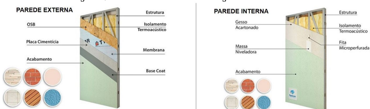
Figura 29: Parede Externa e Interna do Light Steel Frame
