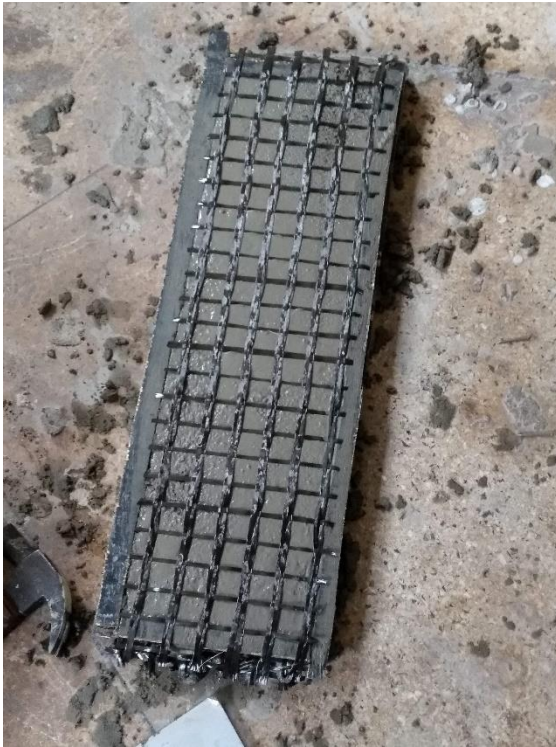
Figura 12 - Confeção do CP de Concreto têxtil
