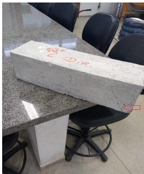
Figura 16 - Fissura em CP de concreto armado
