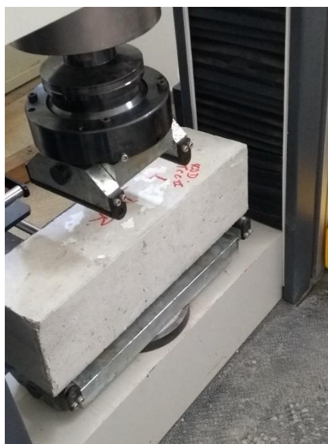
Figura 14 - Ensaio de flexão em CP de concreto armado
