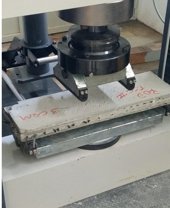
Figura 15 - Ensaio de flexão em CP de concreto têxtil em prensa de dois pontos
