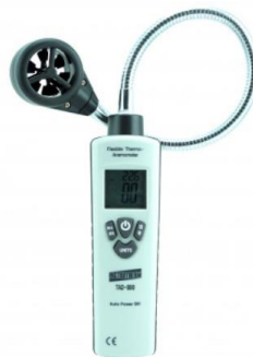
Figura 3 – Termo-Anemômetro Digital Portátil TAD-800 (Instrutherm).
