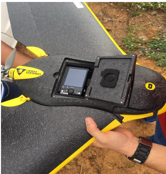
Figura 20 - Posicionamento da câmera - visão da parte superior do VANT
