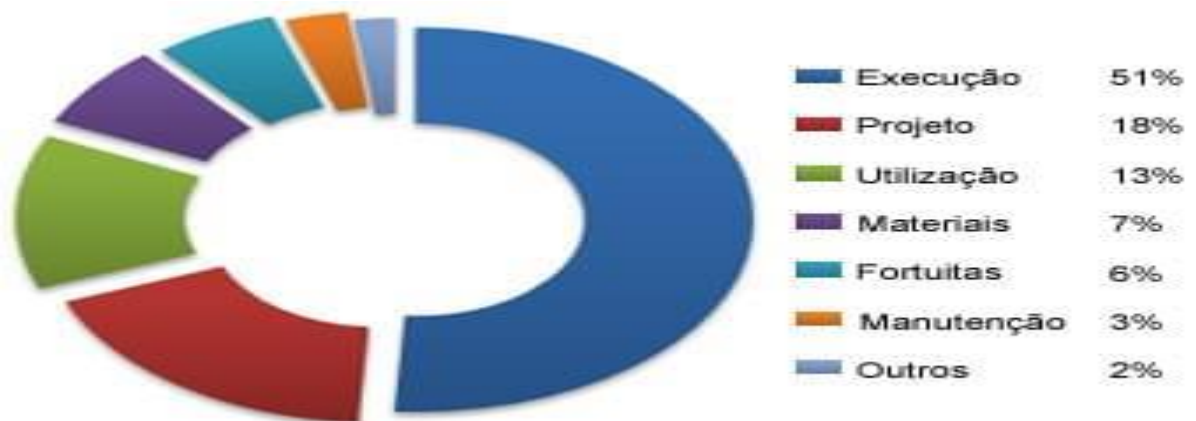
Figura 9 - A origem de uma patologia está relacionada com a etapa da vida da estrutura
