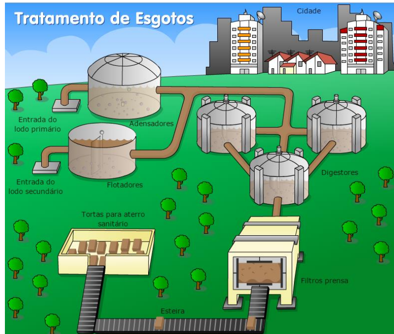
Figura 2 – Tratamento da fase sólida de esgotos Fonte: SABESP - 2013.
