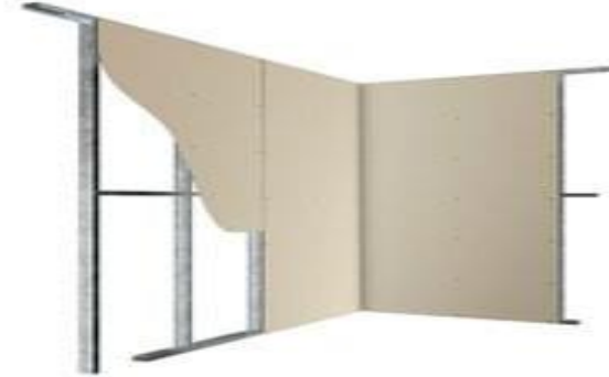
Figura 16. Fechamento interno com dry-wall
