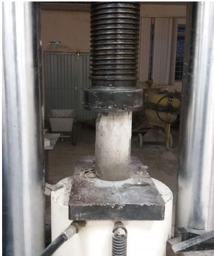
Figura 6 – Execução do ensaio de compressão em prensa hidráulica.
