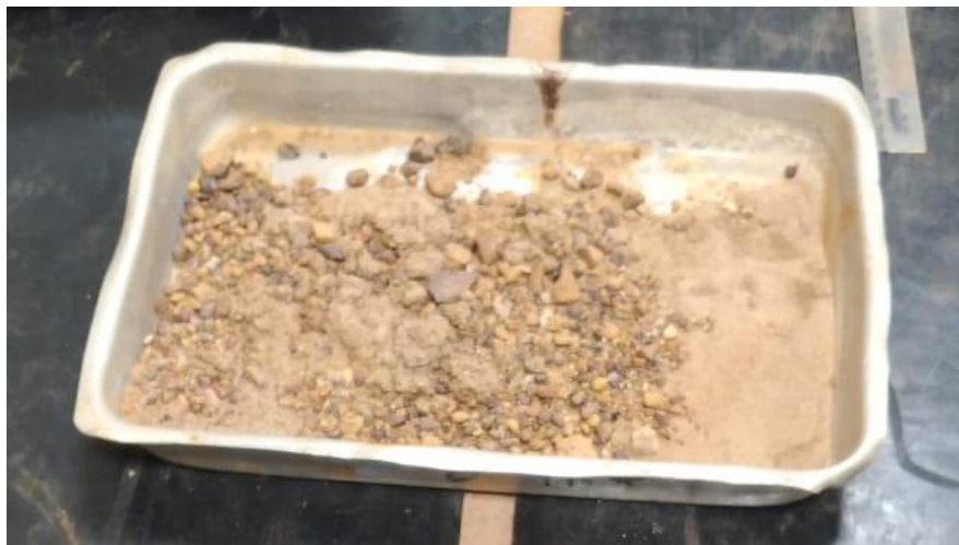
Figura 6 – Preparação de amostra para Granulometria Solo Referência
