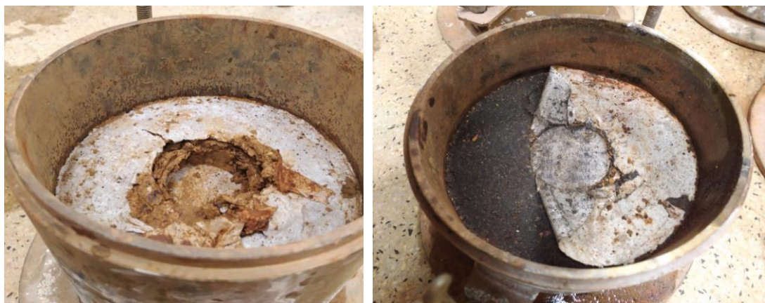
Figura 14 – Comparativo de penetração das amostras depois de rompida
