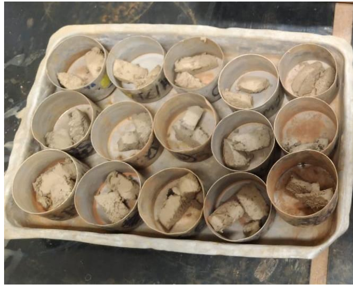
Figura 12 – Determinação Massa Seca Limite de Liquidez
