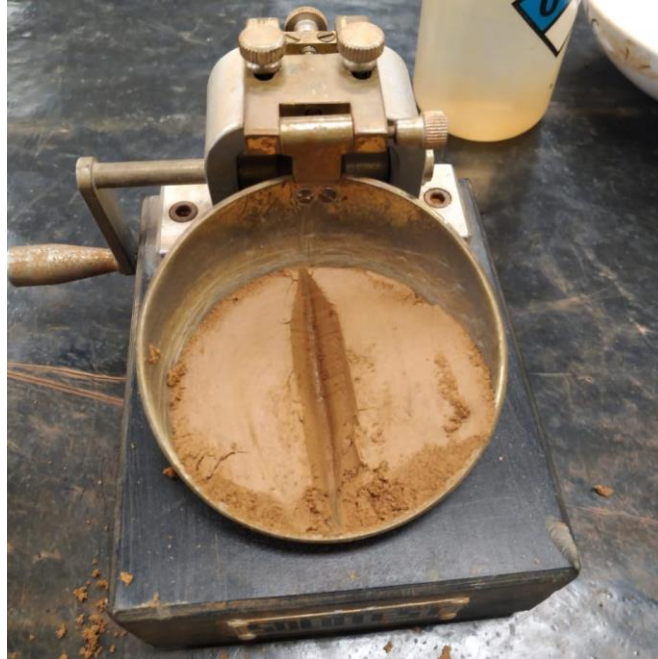
Figura 9 – Ensaio de Limite de Liquidez do Solo de Referência.
