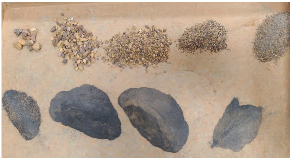
Figura 7 - Ensaio de Análise Granulométrica amostra M4
