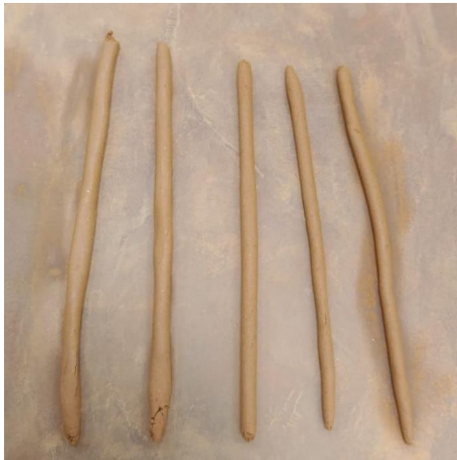
Figura 10 – Ensaio de Limite de Plasticidade do Solo de Referência.
