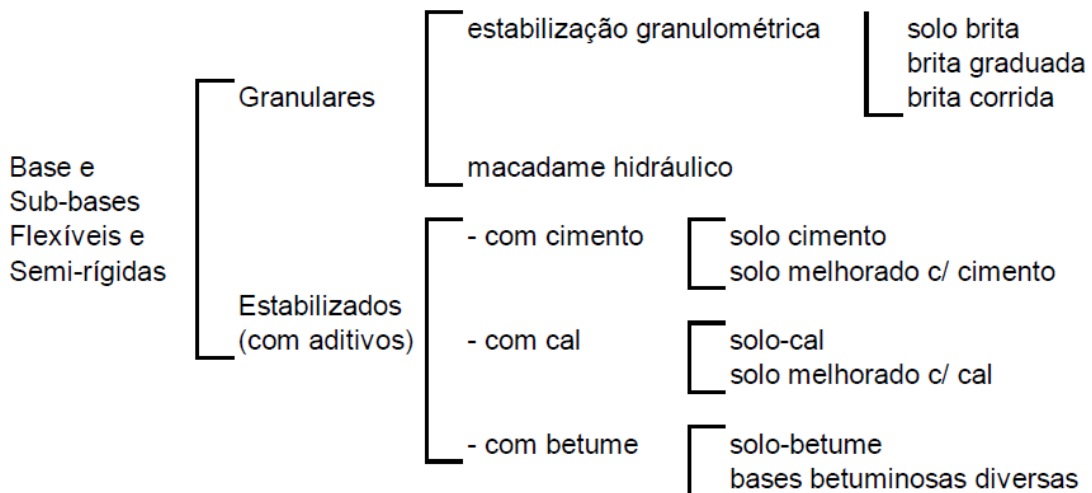
Figura 2 - Classificação das bases e sub-bases flexíveis e semirrígidas
