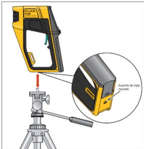
Figura 19a – Montagem de termovisor no tripé
