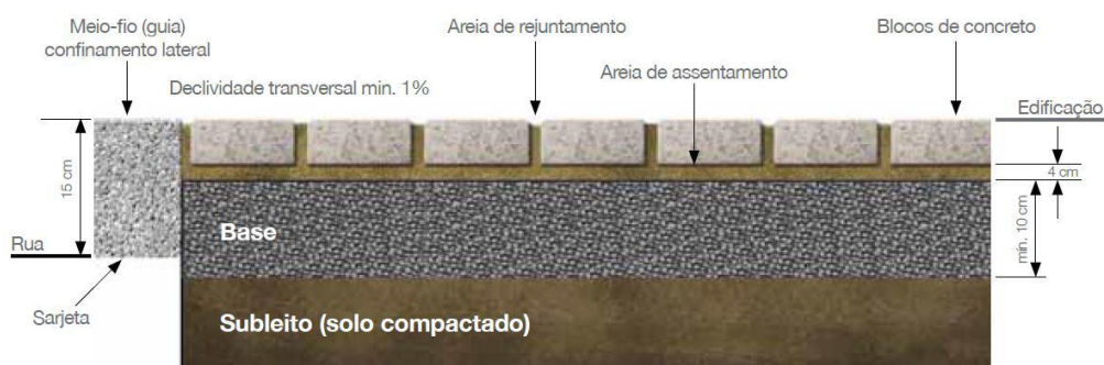
Figura 4 - Estrutura pavimento intertravado
