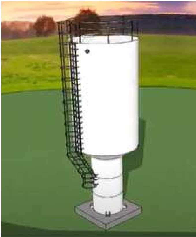
Figura 18: Reservatório Metálico Tipo Taça
