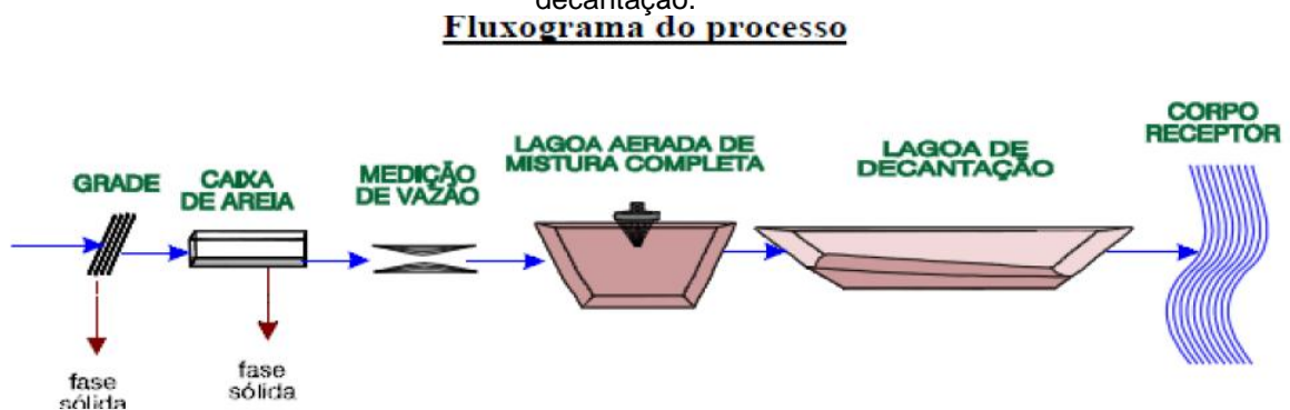
Figura 7 - Fluxograma típico de um sistema de lagoas aeradas de mistura completa – lagoas de decantação.
