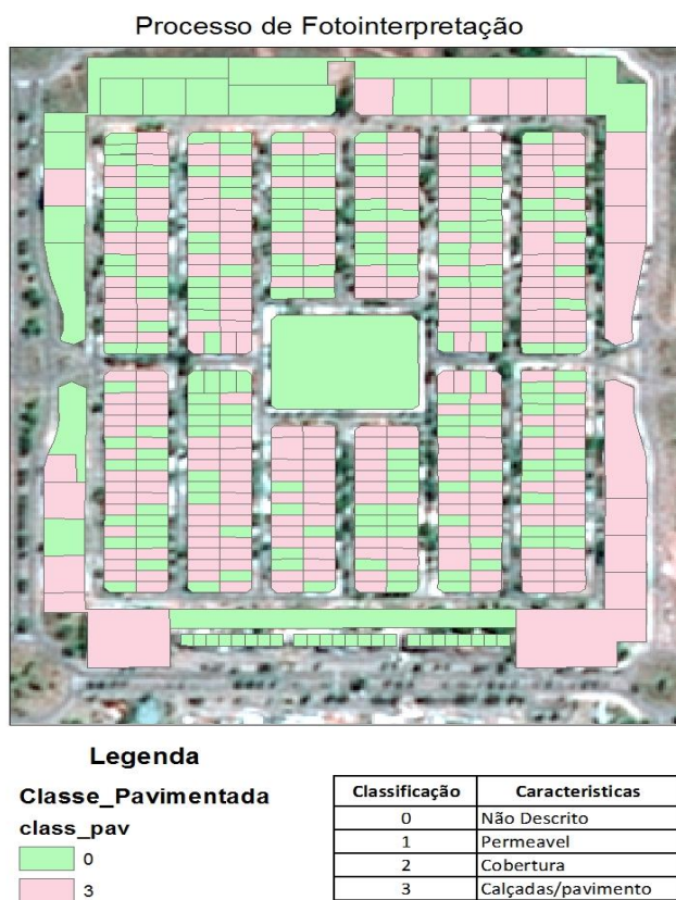
Figura 36: Classificação de Áreas Pavimentadas. Fonte: Próprio Autor
