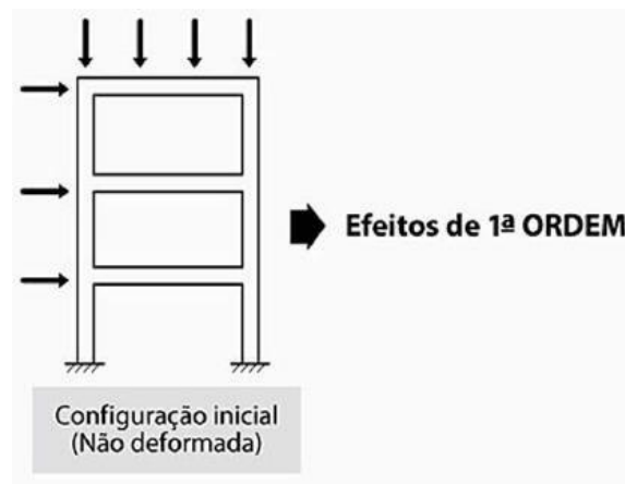
Figura 3 - Estrutura submetida a efeitos de 1ª ordem
